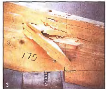
Соединение на шурупах с квадратной головкой в условиях перегрузки
