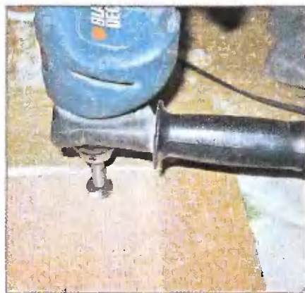
Глухие пазы под мебельные петли разметил по шаблону, а затем выбрал сверлом Форстнера
