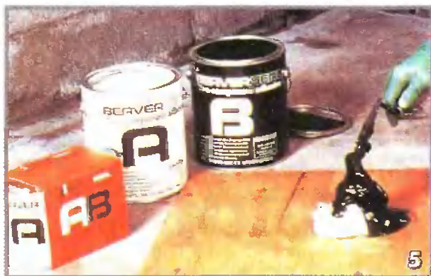
5 Двухкомпонентный эпоксидный клей нужно приготовить в строгом соответствии с инструкцией на упаковке
